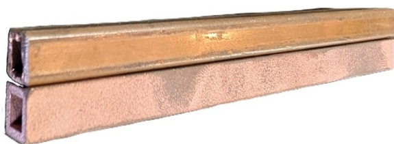
شکل 6- نمونه پرینت سه بعدی در پایین و نمونه اکستروود شده در بالا.
