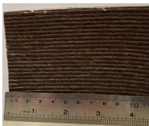
شکل 1- دیواره فولاد زنگ نزن 316L ساخته شده با فرایند ساخت افزایشی قوسی سیمی.
