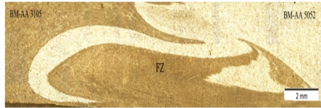
شکل 11- تصویر میکروسکوپی نمونه FSW 3-5 و نمایش مناطق BM، FZ.
