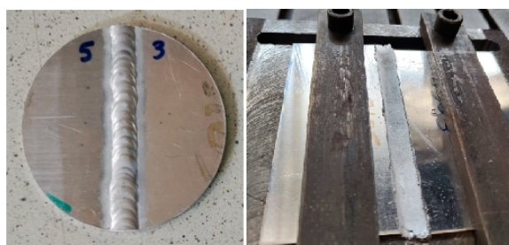
شکل 5- نمونه جوشکاری شده به روش الف - FSW و ب - TIG.
