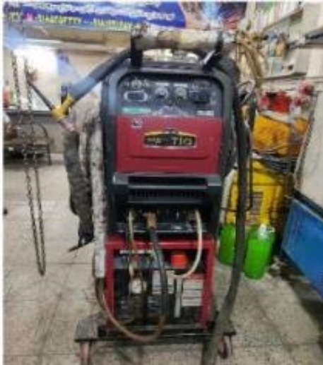
شکل 2- دستگاه مورد استفاده در جوشکاری TIG.
