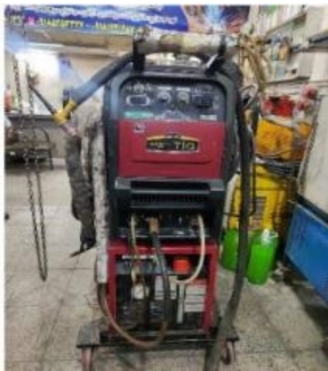
شکل 2- دستگاه مورد استفاده در جوشکاری TIG.
