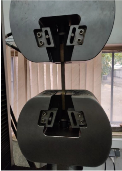
شکل 8- تصویر بارگذاری آزمون کشش بر روی قطعات مورد مطالعه.
