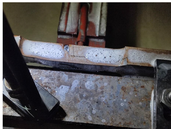
شکل 5- نمایی از برشکاری قطعات جوشکاری شده جهت مطالعه ریزساختار.
