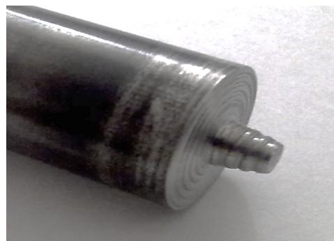
شکل ۲- ابزار طراحی شده جهت جوشکاری اصطکاکی اغتشاشی
