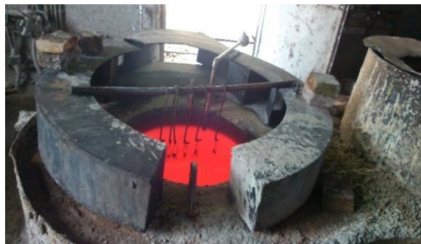
شکل 4- عملیات حرارتی نمونه ها در کوره
