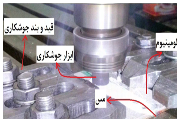
شکل ۱- تصویر فرایند جوشکاری اصطکاکی اغتشاشی
