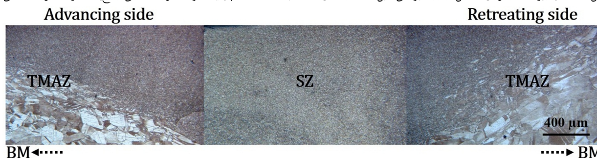
شکل 4- درشت ساختاری از ناحیه اتصال نمونه آنیل شده.
