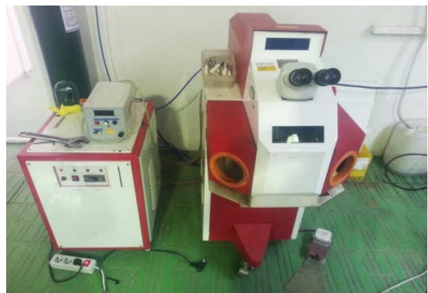
شکل 2- دستگاه جوش لیزر پالسی
