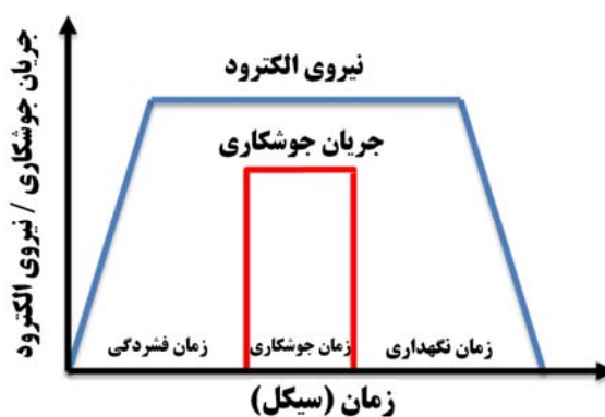
شکل 2- شماتیک یک سیکل جوشکاری مقاومتی نقطه ای.
