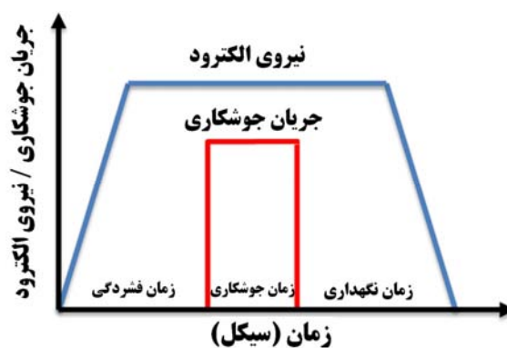
شکل 2- شماتیک یک سیکل جوشکاری مقاومتی نقطه ای.
