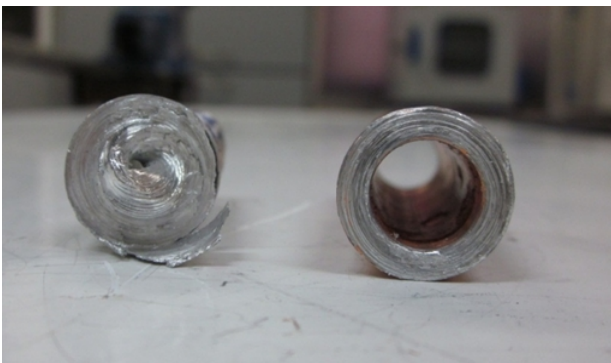
شکل 16- نحوه شکست نمونه‌های گروه سوم
