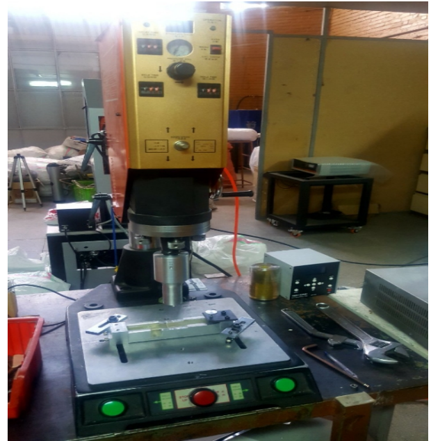
شکل 3- بدنه تغذیه دستگاه جوشکاری فراصوتی 2600 وات ساخت شرکت مکس واید
