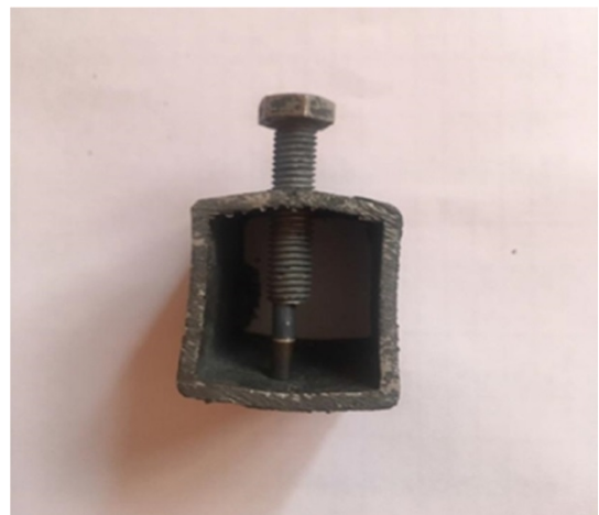
شکل 2- نحوه قرارگیری نمونه‌ها در فیکسچر
