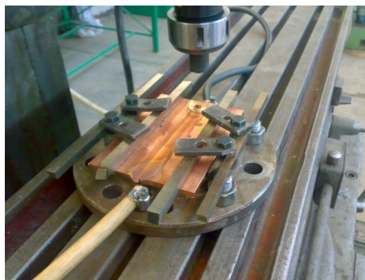
شکل 1- قالب جوشکاری مجهز به سیستم خنک کننده.
