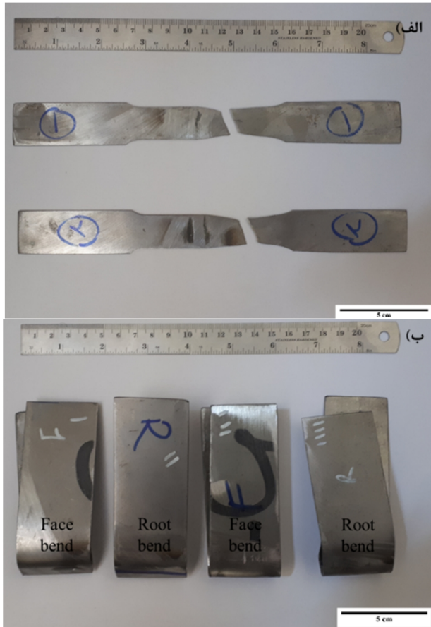
شکل 9- نمونه‌های اتصال غیرهمجنس بعد از الف- آزمون کشش ب- آزمون خمش ریشه و خمش گرده جوش.
