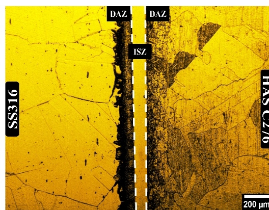
شکل 3- تصویر میکروسکوپ نوری (OM) اتصال انجام شده در دمای
