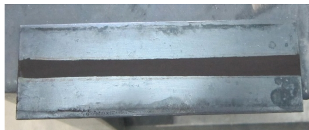
شکل 1- نمونه آماده سازی با پودر CuO.
