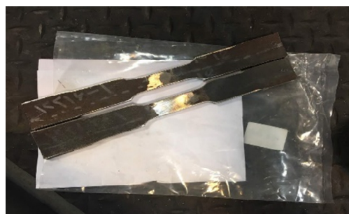
شکل 4- نمونه قطعه آماده شده برای آزمایش کشش.
