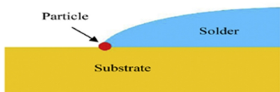
شکل 5- شماتیک محل قرارگرفتن نانو ذرات حین لحیم کاری [5].
