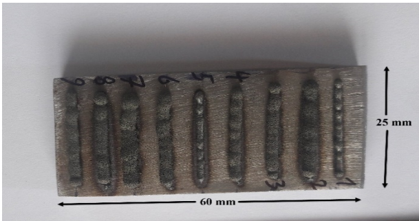
شکل 2 - برخی از پوشش های لیزری ایجاد شده بر روی قطعه زیر لایه.
