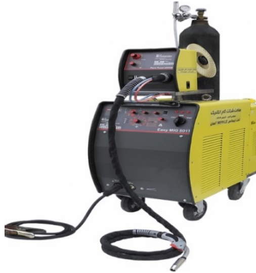
شکل 4- دستگاه جوشکاری قوس الکتریکی با گاز محافظ.
