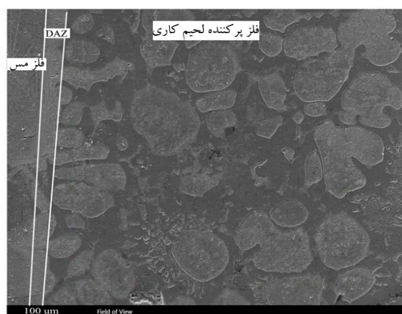
شکل 15- تصویر میکروسکوپی الکترونی روبشی از اتصال \text{Al}_2\text{O}_3/\text{Cu} با فلز پرکننده Ag-Cu-Ti-Sn-3.5Zr
