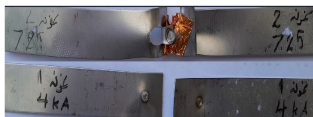
شکل 6- حالت شکست در نمونه‌ها: تصویر بالا شکست محیطی، تصویر پایین شکست فصل مشترکی.
