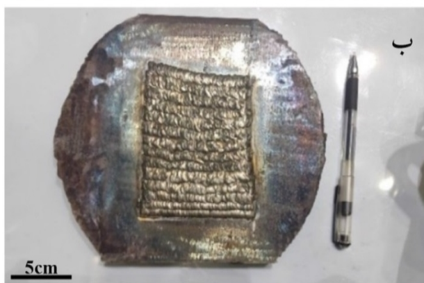
شکل 2- وضع ظاهری روکش‌های ایجاد شده: الف - اعمال پوشش کلمونوی به روش قوس تنگستن ب- اعمال پوشش کلمونوی به روش قوس پلاسما
