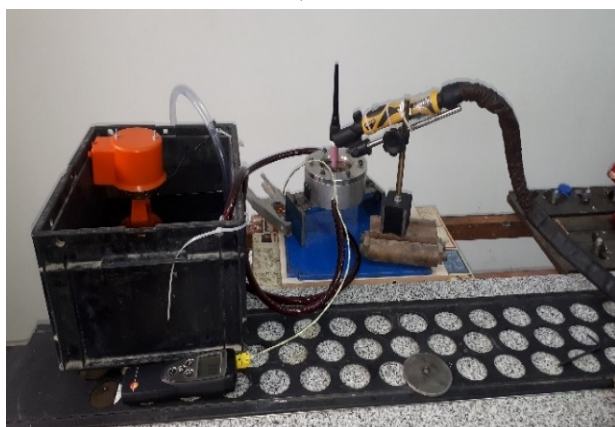
شکل 3-ستاپ آزمایش عملیات حرارتی قوسی روی نمونه ها.
