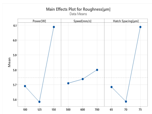
شکل 3 - نمودار اثرات اصلی پارامترهای ورودی شامل توان لیزر، سرعت اسکن لیزر و مقدار همپوشانی لایه‌های مجاور بر زبری سطح نمونه‌های تولید شده با روش SLM
