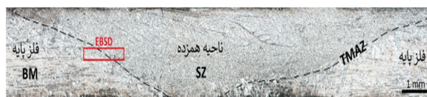
شکل 1- ماکروساختار نمونه جوشکاری شده. ناحیه مورد بررسی توسط آنالیز EBSD به وسیله مستطیل قرمز مشخص شده است.
