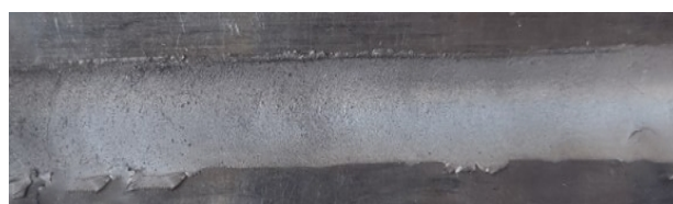
شکل 2- مورفولوژی سطحی جوشکاری اصطکاکی.
