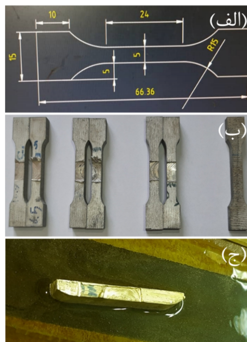
شکل 6- الف - شماطیک نمونه تست کشش، ب - تصویر نمونه‌های تست کشش و ج - نمونه متالوگرافی.
