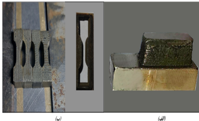
شکل 4- نمونه ساب‌سایز آزمون کشش
