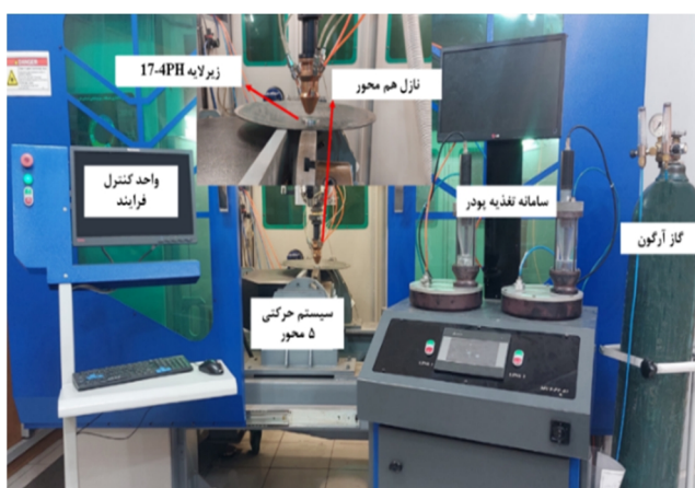
شکل 3- سامانه رسوب‌نشانی مستقیم لیزری آزمایشگاه.
