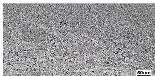
شکل 19- ریزساختار TMAZ در نمونه با شیار به عمق 1/5 میلیمتر.
