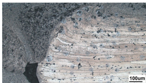
شکل 23- حفره‌های قابل مشاهده در نمونه 0.5 میلیمتری.
