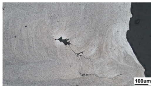
شکل 24- حفره‌های قابل مشاهده در نمونه 2 میلیمتری.
