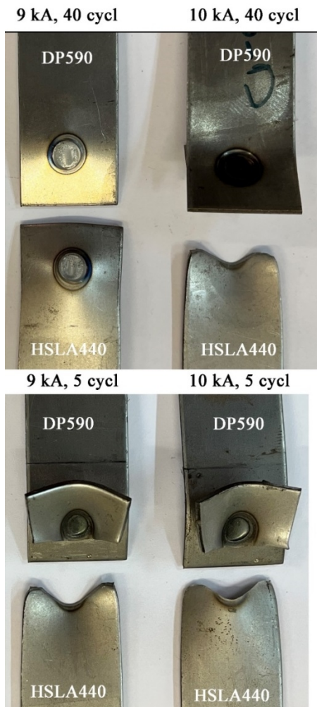
شکل 5- تصاویر شکست نمونه‌ها پس از آزمایش کشش در جریان‌های 9 و 10 و زمان‌های نگه‌داری 5 و 40 سیکل.
