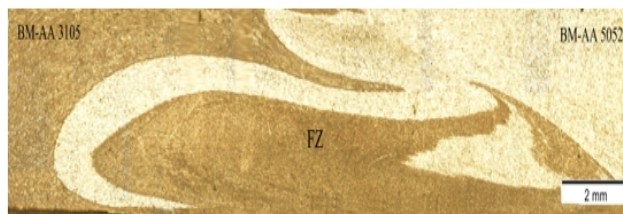
شکل 11- تصویر میکروسکوپی نمونه FSW 3-5 و نمایش مناطق BM، FZ.
