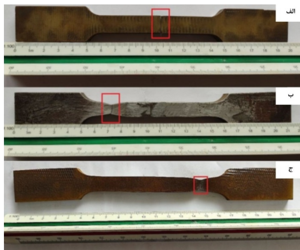
شکل 20- قطعات آزمون کشش بعد از انجام آزمون، الف- قطعه جوشکاری شده SMAW بدون آماده‌سازی و پخ‌زنی (S1)، ب- قطعه جوشکاری شده SMAW با استاندارد آماده‌سازی و پخ‌زنی (S2) و ج- قطعه جوشکاری شده GMAW با استاندارد آماده‌سازی و پخ‌زنی (G1).
