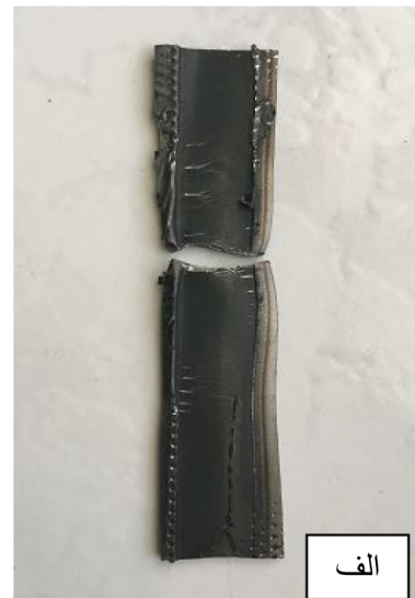
شکل ۵- الف) تصویر شکست نمونه جدا شده در راستای جوش (ب) نمودار نیرو- جابجایی نمونه ای با بیشترین استحکام
