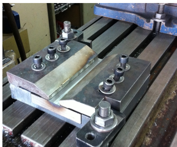
شکل ۲- فیکسچر مورد استفاده در آزمایشات تجربی جوشکاری اصطکاکی اغتشاشی ورق های فولادی با ضخامت ۰/۷ میلیمتر
